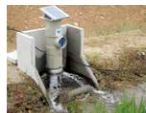
▲圃場に設置された遠隔水管理制御装置。端末の画面で圃場の状態が確認できる。(写真提供: 俵ファーム)
